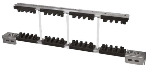
Система наборных шинодержателей позволяет создать требуемую конфигурацию шинодержателя в зависимости от требований проекта. Основанием служит прочный алюминиевый перфорированный профиль, на который насаживаются изоляторы для установки силовых шин ребром. Изоляторы имеют различное исполнение, обеспечивающее возможность установки шин толщиной 5 и 10 мм в количестве от двух до четырех на одну фазу. В составе комплектов идет необходимый крепеж: гайки, шпильки, винты.
