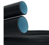
Двустенная гибкая труба открытой прокладки устойчива к ультрафиолету и не распространяет горение. Гибкость труб позволяет осуществлять обход препятствий на пути следования кабельной трассы без применения дополнительных аксессуаров.
