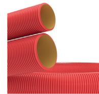
Двустенные гибкие трубы скрытой прокладки обеспечивают дополнительную механическую защиту и изоляцию кабеля, а также возможность замены проводки. Высокая эластичность и прочность труб в сочетании с 50-летним сроком службы позволяет их использовать при высоких ударных нагрузках на грунт и заливке бетоном и сэкономить средства на обслуживание.
