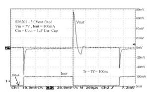
Fig. 33: Load Transient Response, 100mA step, 7V<sub>IN</sub>
