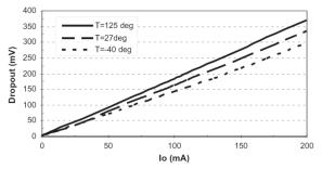
Fig. 4: Dropout vs. Io (SP6201 fixed 3.0V)
