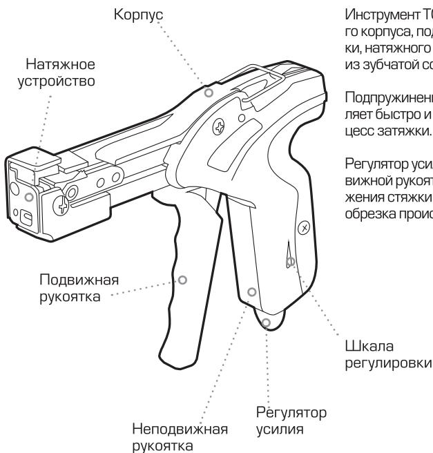
Инструмент TG-05 состоит из литого стального корпуса, подвижной и неподвижной рукоятки, натяжного устройства с пазом, состоящего из зубчатой собачки, механизма и пружин.
