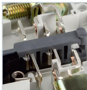
Особая конструкция контактной системы мостикового типа гарантирует максимально надежный контакт во включенном состоянии и двойной разрыв цепи в выключенном.
